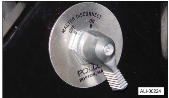
Interruptor de corriente instalado en la cabina del camión.
