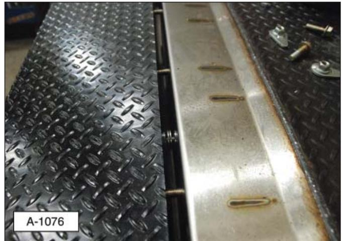
3. La extensión de piso tiene una inclinación natural que se debe enderezar a medida que se la instala. Ajuste los tornillos desde el centro hacia afuera, manteniendo la extensión nivelada con respecto a la plataforma del camión.
