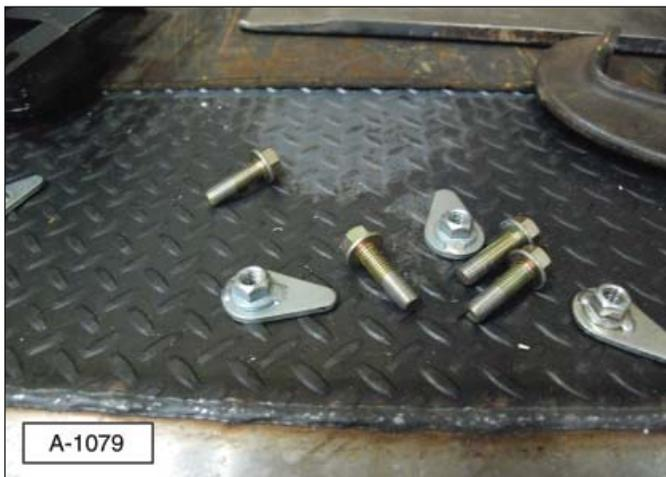
**Nota:** En algunas aplicaciones, se deben instalar dos arandelas grandes en cada uno de los pernos inferiores para mantener la extensión nivelada y en paralelo con la plataforma del camión.
