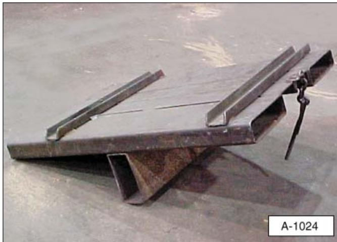
Dispositivo de elevación construido por el instalador.
